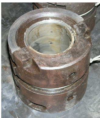
Рисунок 1 - Некачественная заливка баббитового слоя подшипника скольжения
