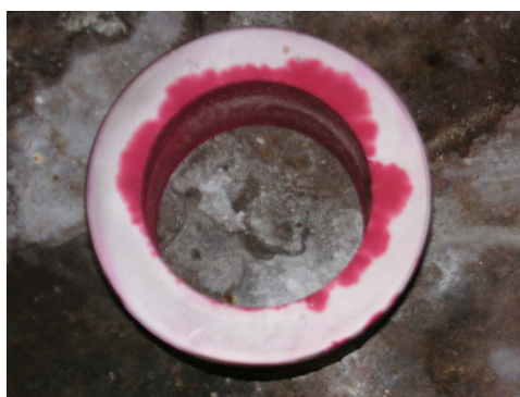
Рисунок 2 - Проверка качества адгезии антифрикционного слоя методом цветной дефектоскопии
