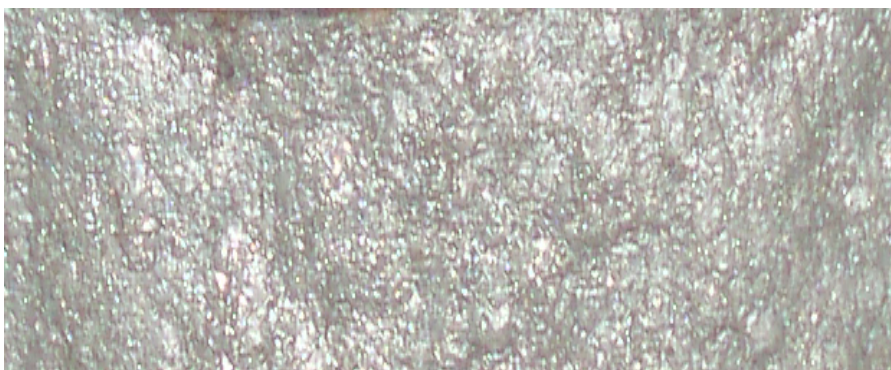
Рисунок 7 - Антифрикционный баббитовый слой после выравнивания серебром
